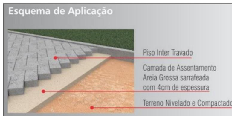
Figura 5 – Imagem do assentamento do piso intertravado
