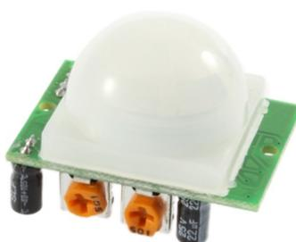
No módulo há 3 pinos para se conectar ao Arduino: o *Vcc* que é a alimentação que será conectada na porta de 5 V da placa, o *GND* que é o retorno para se conectar na porta de mesmo nome do Arduino e o pino *OUT*, que é a saída do sinal do sensor. Este último é conectado em uma das portas digitais que é definida pelo código do projeto.
