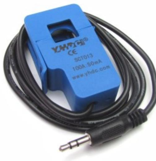
O problema com este amperímetro é que a saída dele é em corrente e o Arduino aceita apenas sinais em tensão. Então, faz-se necessário um circuito auxiliar que transforme a saída de 0 a 50mA em um sinal entre 0 a 5 V que seja legível para o Arduino.
