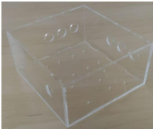
O fundo da caixa possui pequenos furos projetados para encaixar o Arduino e os relés e prende-los com parafusos. No lado direito existem 3 aberturas circulares com 2 cm de diâmetro para a saída dos fios que saem do Arduino até os sensores de presença. Na parte superior, também há 3 aberturas similares, mas estas servem para conectar os fios do quadro de distribuição nos relés dentro da recipiente. Já no lado esquerdo existe um buraco de 2 cm que vai servir para o fio da alimentação do Arduino.
