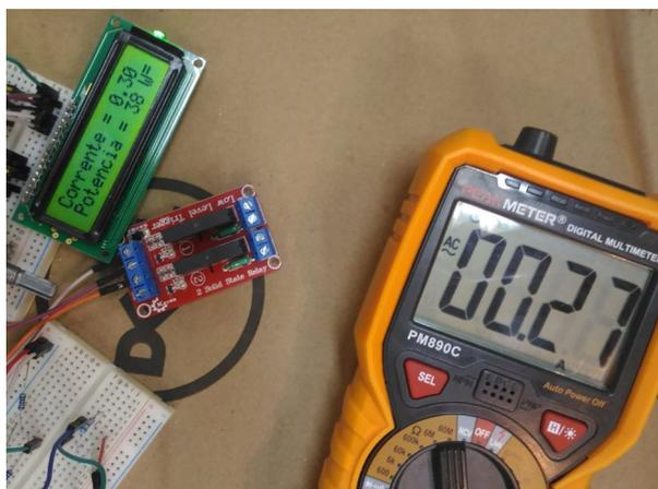
Com isso todo o projeto foi montado e testado aos poucos: primeiro os sensores *PIR* e a tela LCD, depois os relês, o módulo *RCT*, o sensor de corrente e ainda o ESP8266. No final a primeira versão do protótipo estava pronta, faltando apenas testar o código completo, colocar o projeto no receptáculo e fazer o teste em um local específico.
