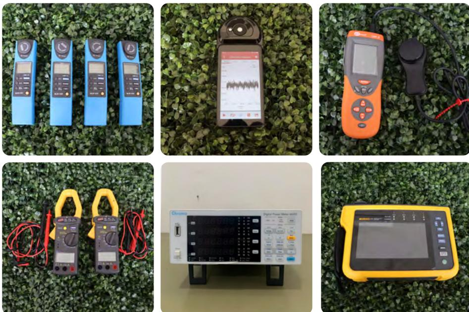
Da esquerda para a direita: figura 2 - Luxímetro simples; figura 3 - Espectrofotômetro com Flicker e Luxímetro com espectrorradiômetro; figura 4 - Luxímetro de alta precisão; figura 5 - Wattímetros portáteis; figura 6 - Multímetro de bancada; figura 7 - Analisador de Energia
